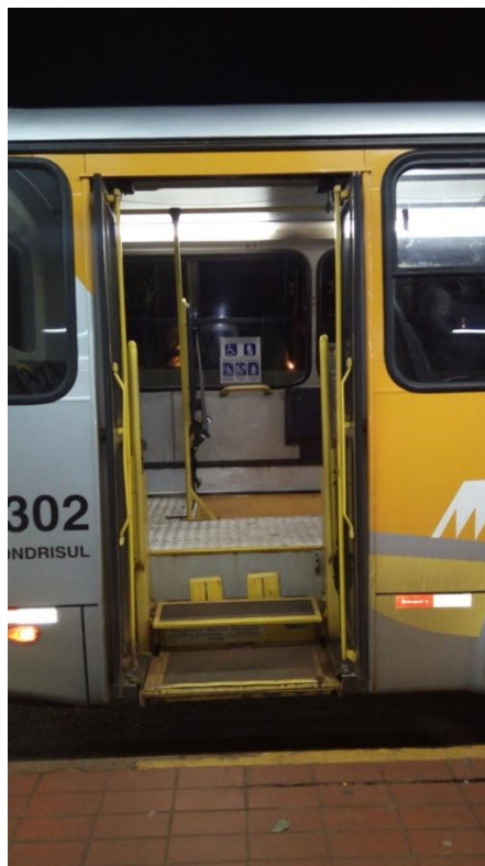
Figura 15: Plataforma elevatória em um veículo de médio porte.
