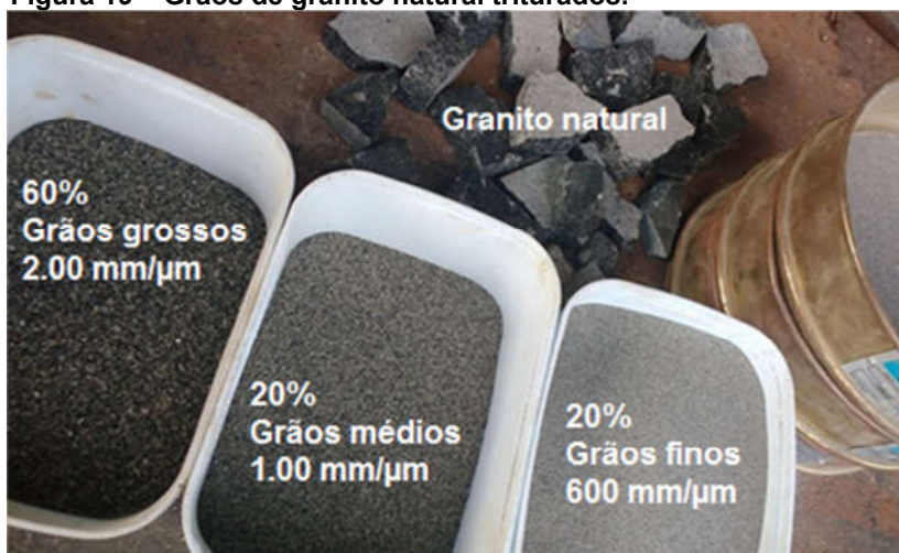
Figura 19 – Grãos de granito natural triturados.
