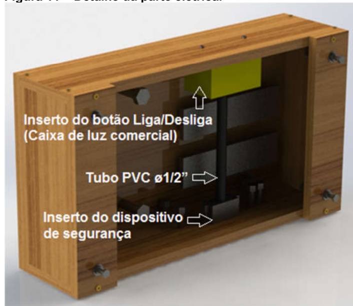
Figura 11 – Detalhe da parte elétrica.
