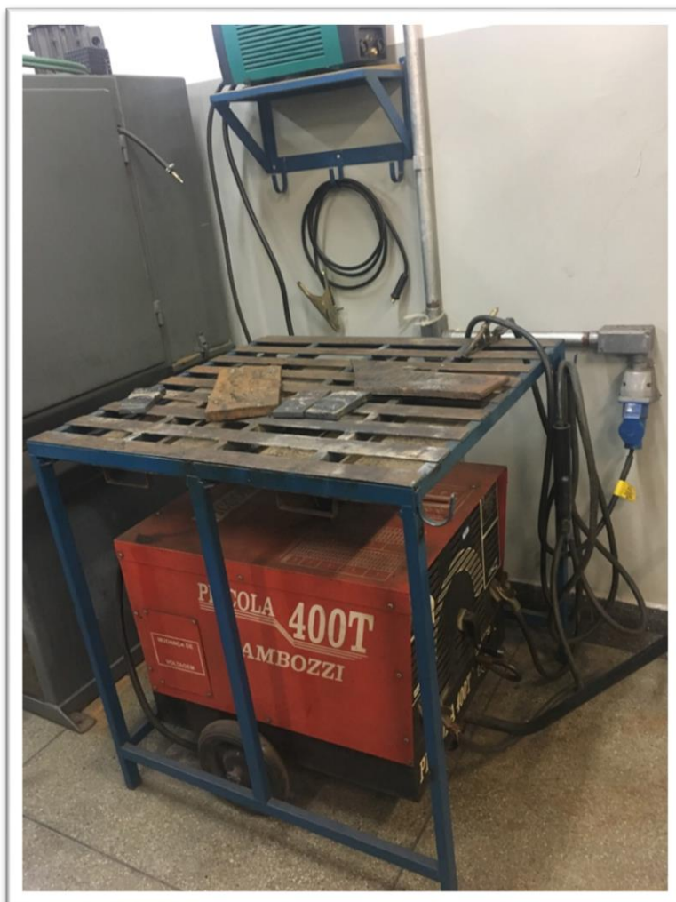
Figura 4: Equipamento de soldagem por eletrodo revestido
