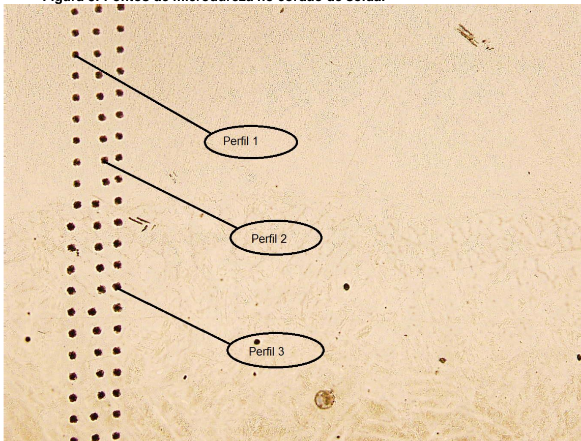
Figura 8: Pontos de microdureza no cordão de solda.
