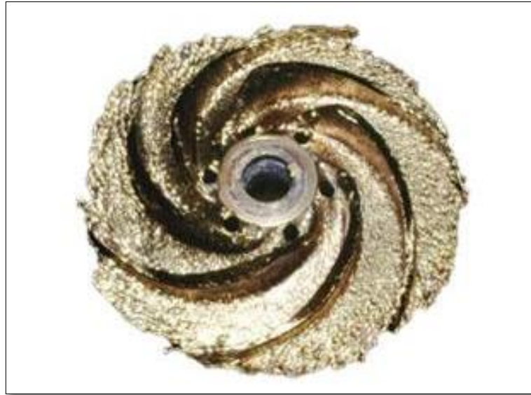
Figura 3 - Rotor de bomba centrífuga que sofreu cavitação.
