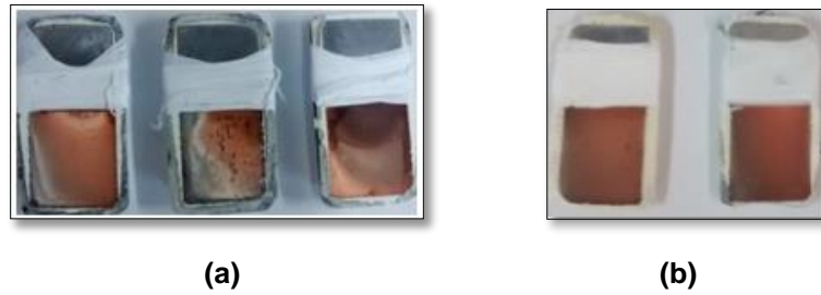
Figura 7 - Depósitos de CuNi em: (a) i_g de 20 \text{mAcm}^{-2} e (b) i_g de 40 \text{mAcm}^{-2} . Obtidos de solução sem SiC. Fonte: Autoria própria.
