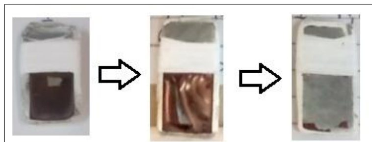
Figura 6 - Depósitos de CuNi a 10 \text{ mAcm}^{-2} de solução sem SiC, nos quais houve o deslocamento do revestimento. Fonte: Autoria própria.
