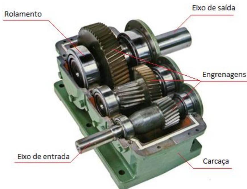
Figura 5 – Representação dos componentes de um redutor de velocidade Fonte: Armário da Engenharia Química UEM.
