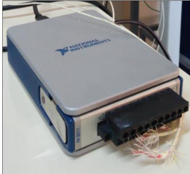
**Figura 4.6 – Módulo de aquisição de temperatura**
