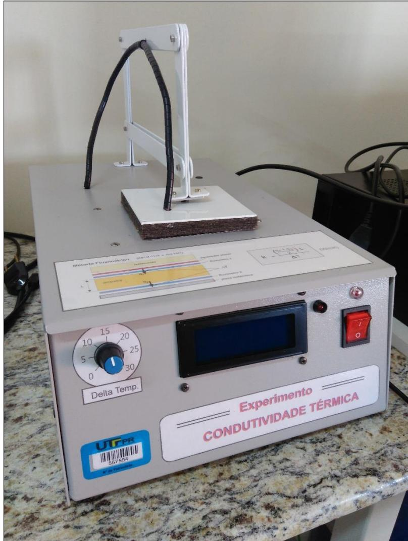
Figura 4.7 – Equipamento gerador do fluxo de calor
