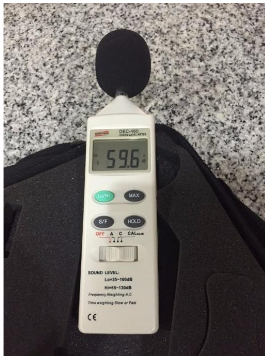
Figura 20 - Decibelímetro Instrutherm dec-460
