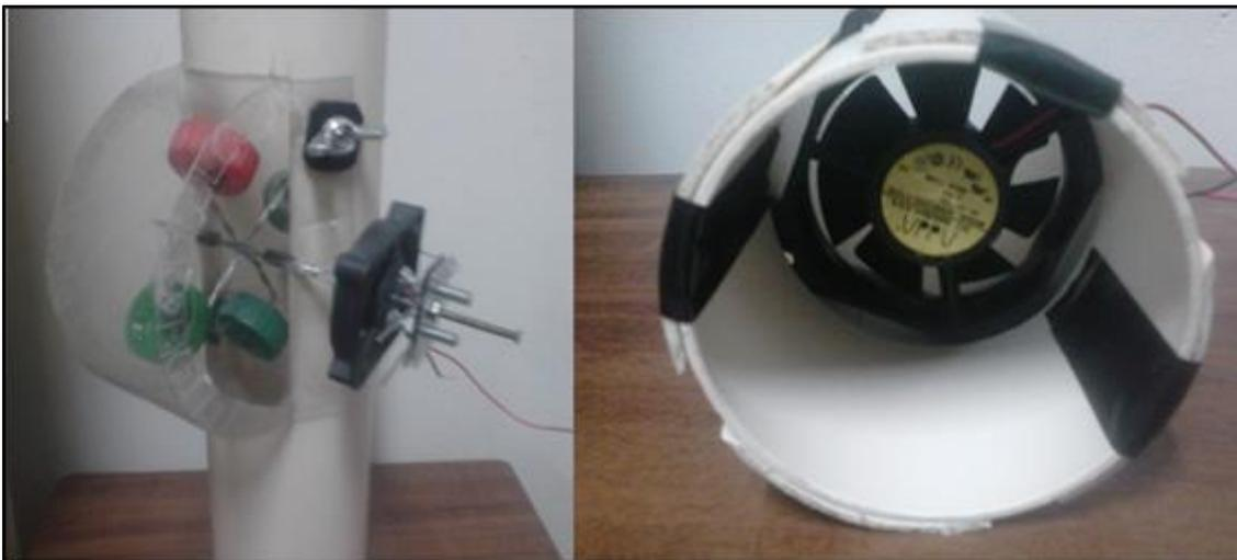
**Figura 12 – Dispositivos construídos na tentativa de controlar a vazão de combustível**
