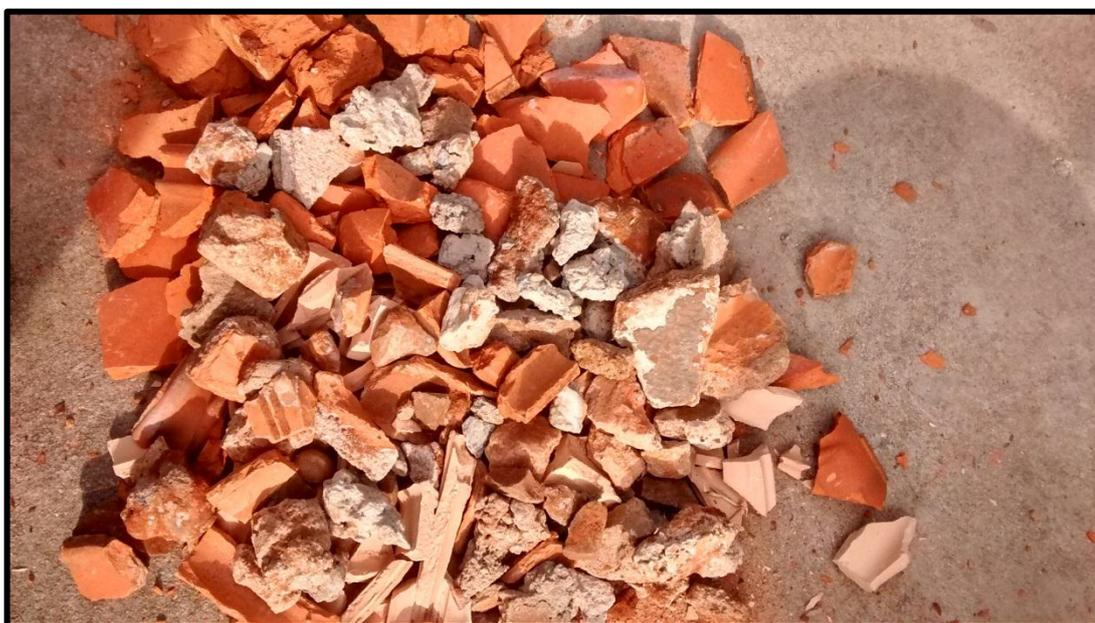
**Figura 9- Resíduos Sólidos de Construção e Demolição analisados.**
