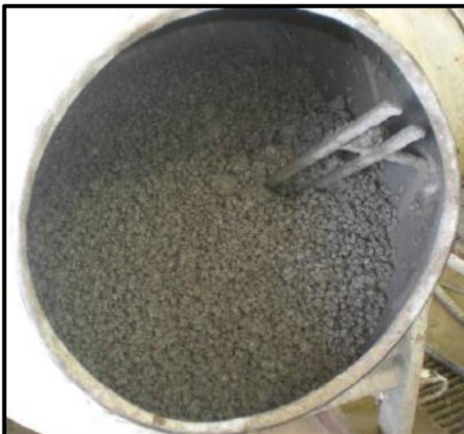
**Figura 11- Mistura base do Concreto Permeável.**
