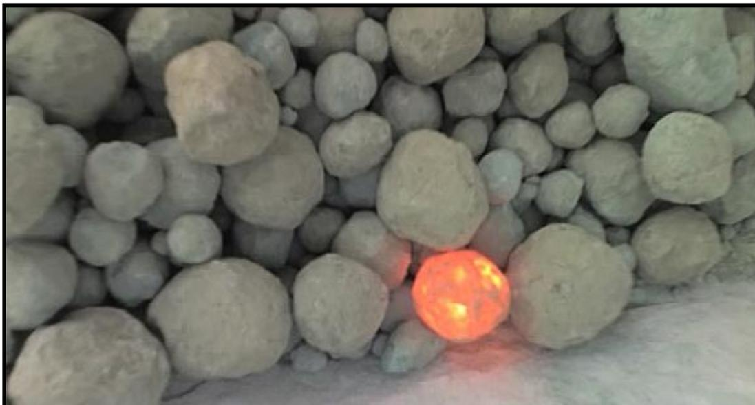
**Figura 6- Clínquer utilizado para a fabricação do cimento.**
