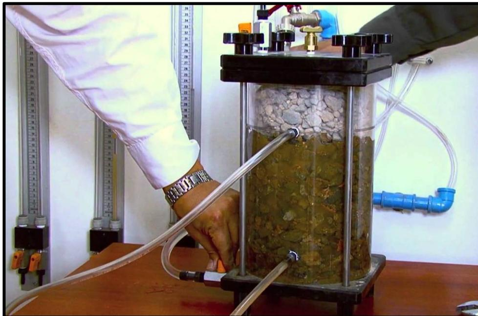
**Figura 10- Permeâmetro, instrumento de medição da permeabilidade.
