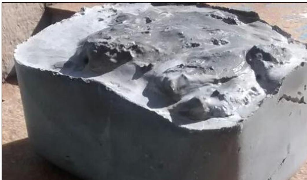
**Figura 13-** Ilustração do primeiro corpo de prova. Não foi observado visualmente características de permeabilidade.
