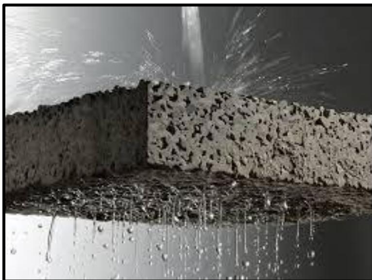
**Figura 3- Ilustração do Concreto Permeável, onde notasse os vazios internos presentes no corpo do concreto (CP).**
