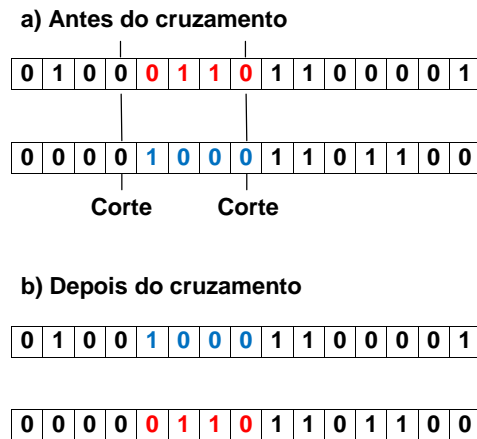
Figura 16: Ilustração de cruzamento dos cromossomos do AG com representação dos cromossomos por um gene alvo. Em (a) par de cromossomos antes do cruzamento das características, com pontos de corte nas posições 3 e 7, e em (b) par de cromossomos após o cruzamento, onde pode ser observado a troca das posições 4, 5, 6 e 7.
