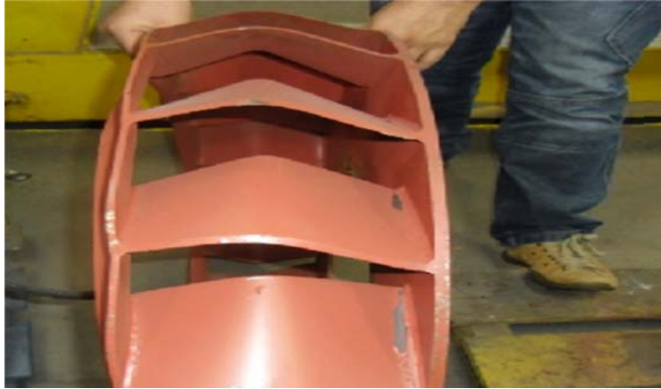
Figura 4 – ventilador de resfriamento interno após o disparo.
