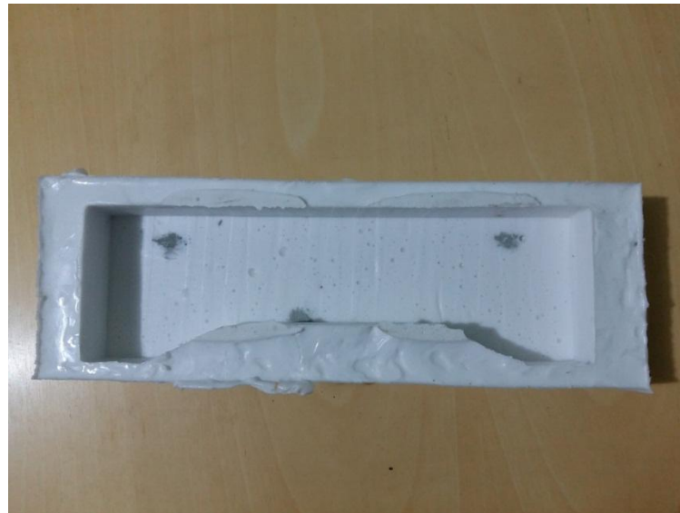
Figura 42: Molde silicone da base de concreto Fonte: A autora (2015)
