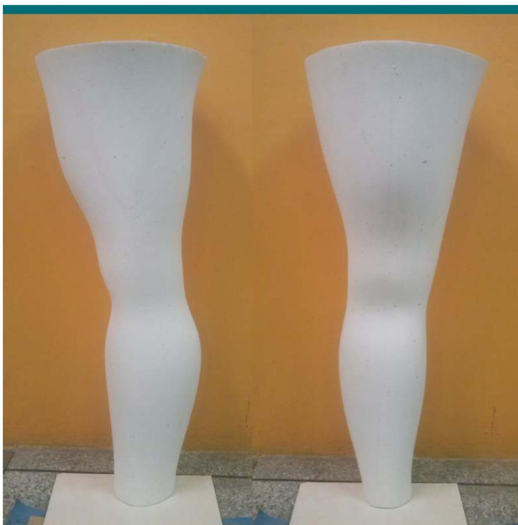
**Figura 47 - Modelo em poliuretano com o acabamento em tinta acrílica branca.**
