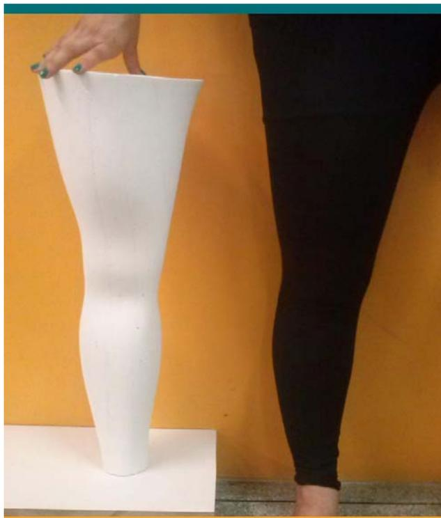
**Figura 49 - Modelo usinado comparado ao membro inferior (vista frontal).**
