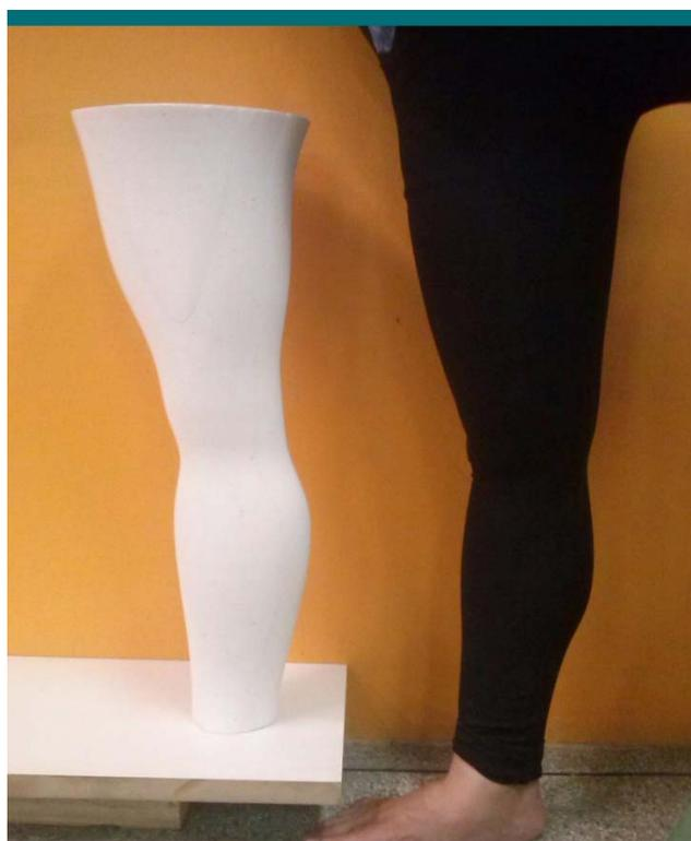
**Figura 50 - Modelo usinado comparado ao membro inferior (vista lateral).**
