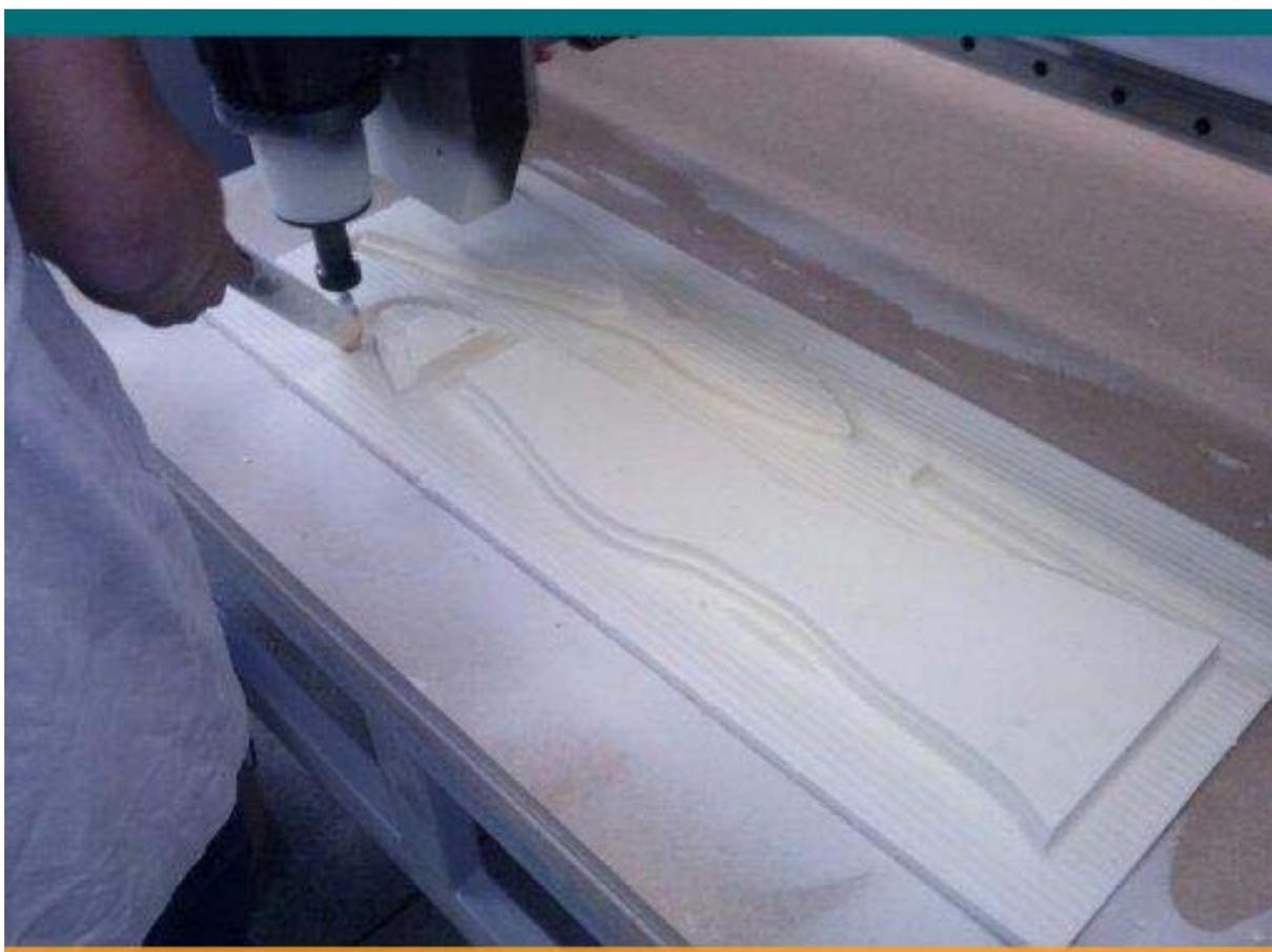
**Figura 43 - Detalhe das duas camadas de 14mm que foram removidas de toda a superfície do material.**
