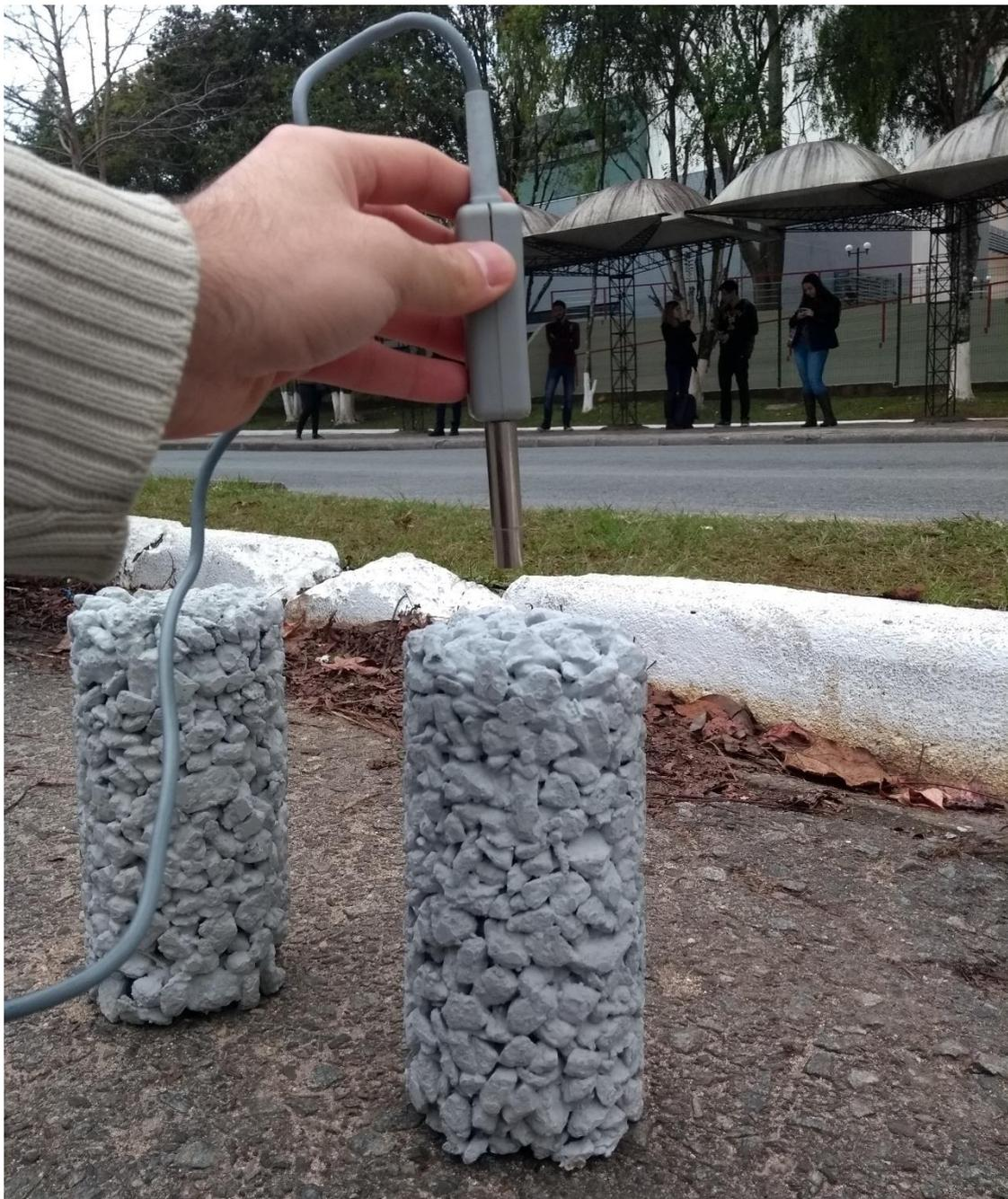
**Figura 14 - Realização do ensaio com o sensor do tipo "sonda"**
