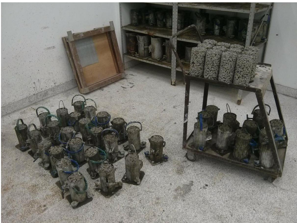
**Figura 10 - Armazenamento dos corpos de prova nas primeiras 24 horas**
