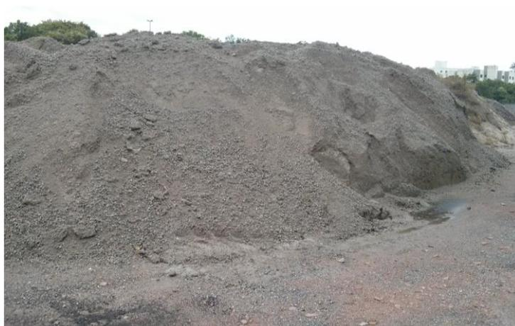
**Figura 7 - Armazenamento do agregado reciclado no Departamento de Manutenção Urbana
