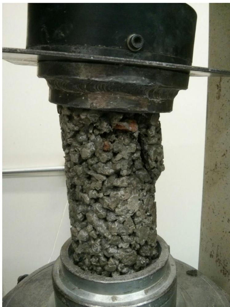
**Figura 11 - Ensaio de compressão axial após rompimento do corpo de prova**
