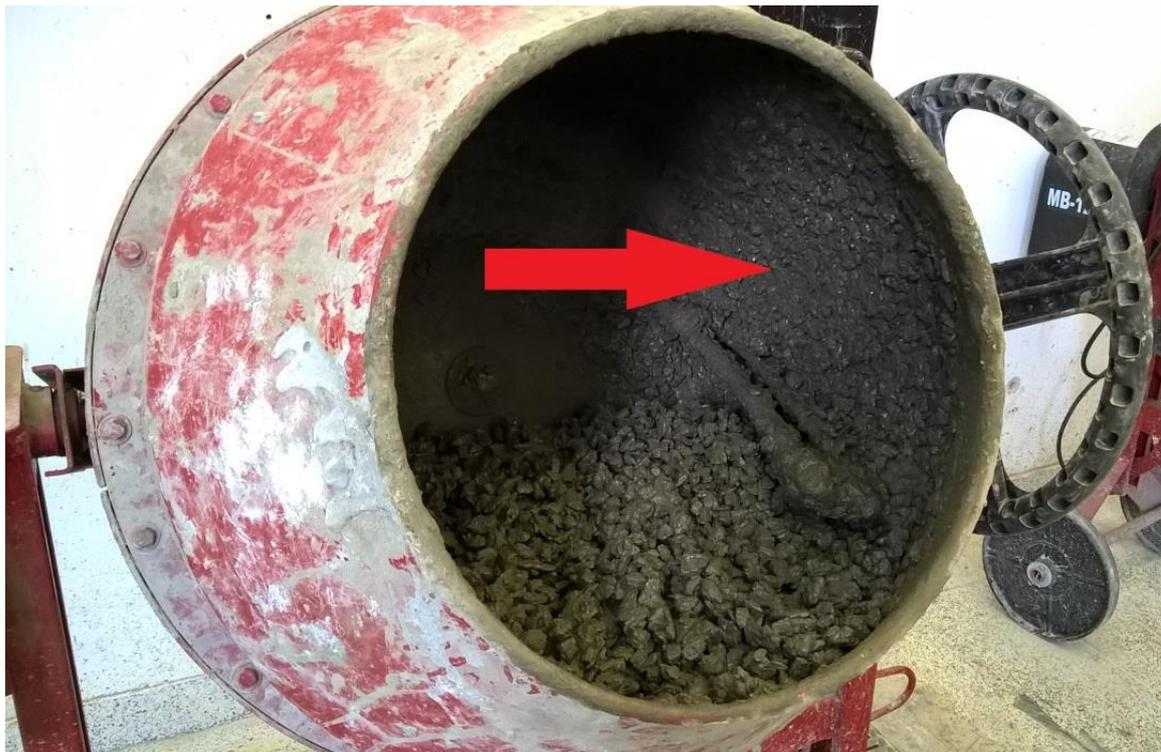
**Figura 15 - Acúmulo de argamassa nas paredes da betoneira**
