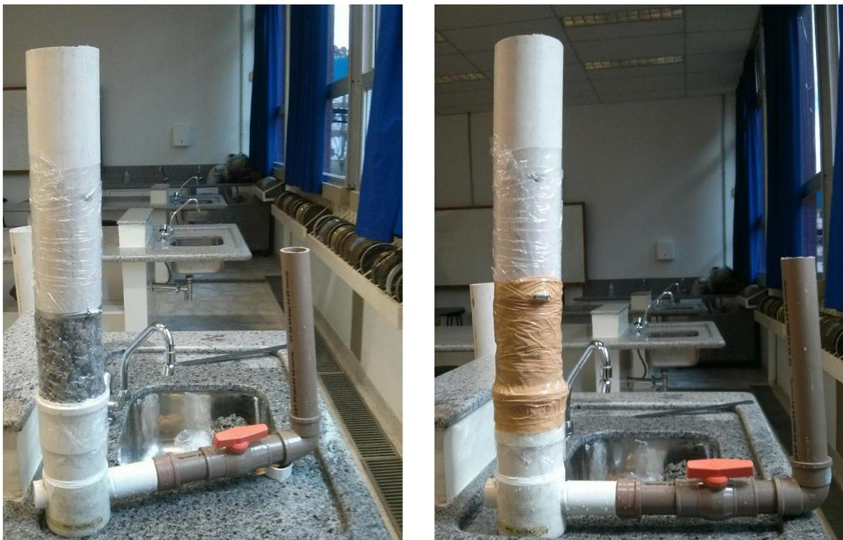
**Figura 12 - Equipamento de determinação da permeabilidade, antes e depois da selagem**
