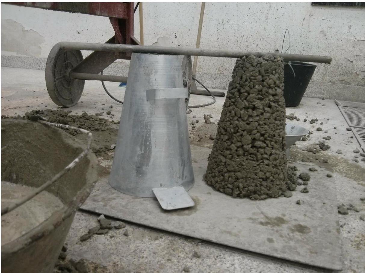
**Figura 16 - Ensaio de abatimento de tronco de cone com o concreto**
