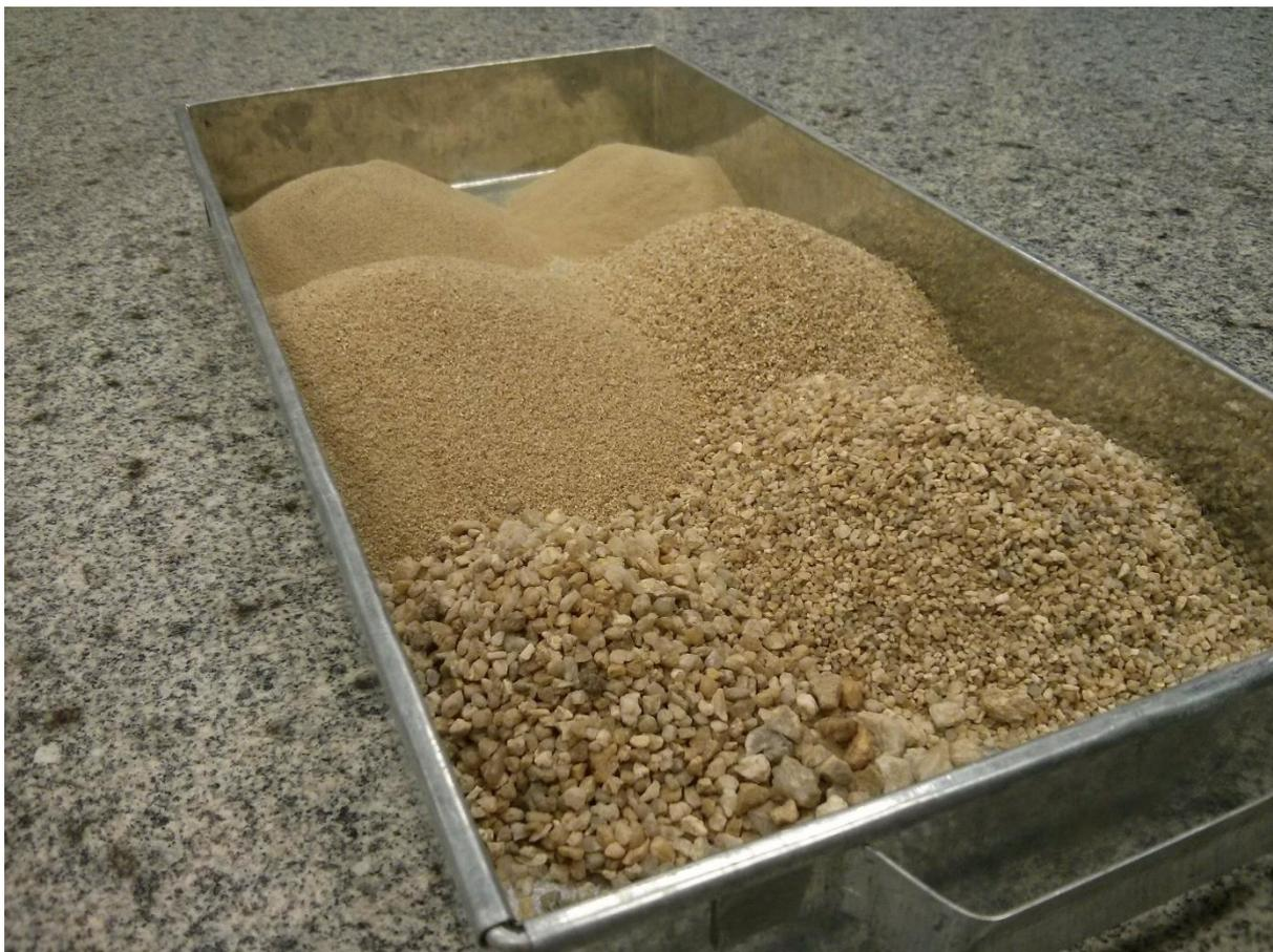
**Figura 9 - Ensaio de granulometria do agregado miúdo virgem**
