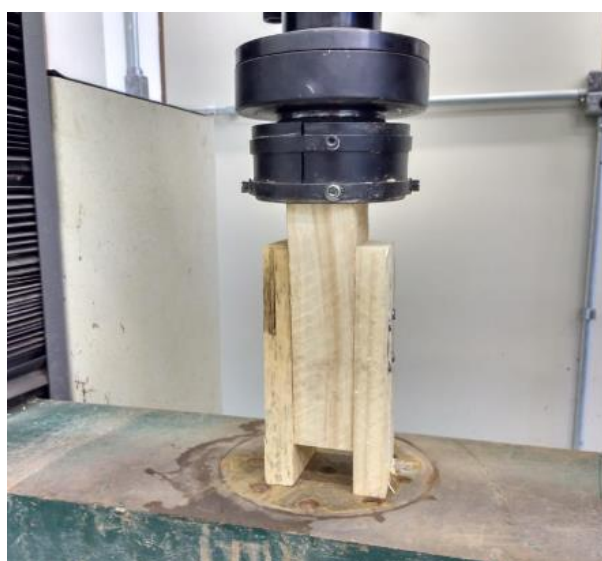
Figura 19: Corpo de prova na prensa de ruptura.
