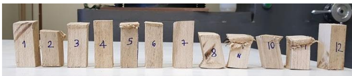
Figura 21: Corpos de prova utilizados para determinação do f_{c,0k} da espécie de Eucalyptus Grandis , após o rompimento
