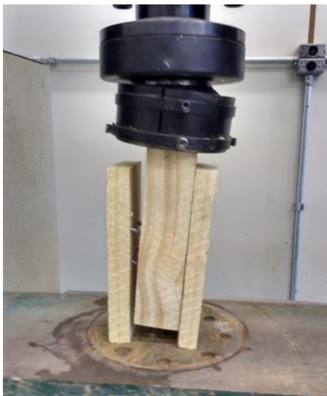
Figura 22: Corpo de prova na prensa de ruptura após a ruptura.
