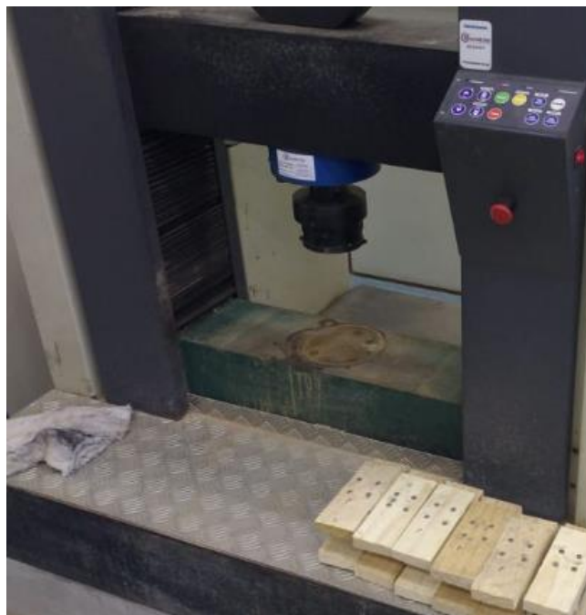
Figura 15: Prensa de compressão marca Emic e modelo DL3000N utilizada nos ensaios.
