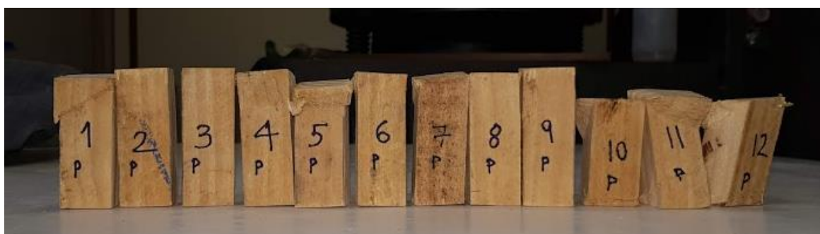
Figura 20: Corpos de prova utilizados para determinação do f_{c,0k} da espécie de Pinus Taeda , após o rompimento.
