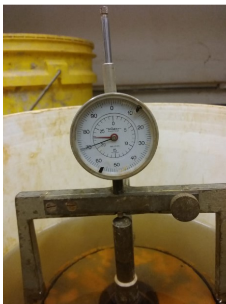
Fig. 12 – Expansão do solo a partir de um extensômetro. Fonte: Autoria própria.
