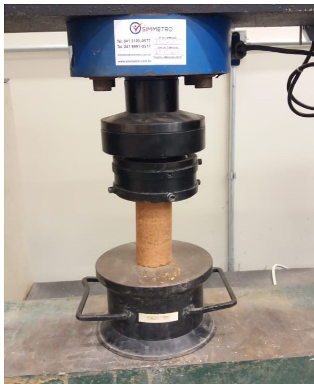
Fig. 11 – Ensaio de resistência à compressão simples. Fonte: Autoria própria.
