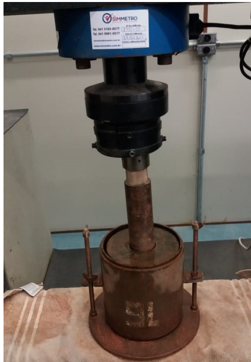
Fig. 13 – Ensaio de penetração. Fonte: Autoria própria.
