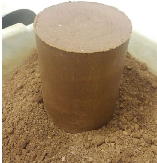
Fig. 09 – Corpo de prova moldado no ensaio de compactação. Fonte: Autoria própria.
