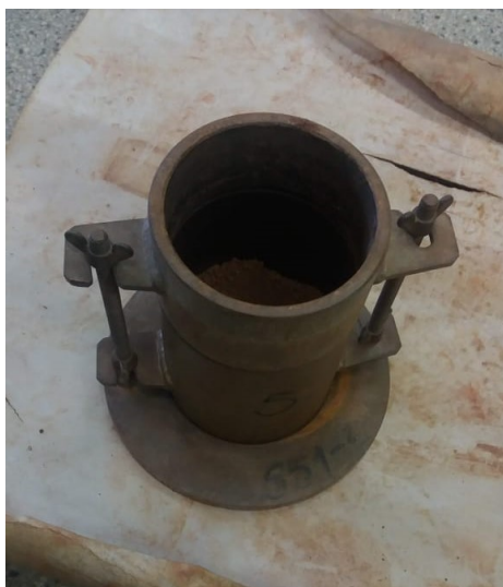
Fig. 08 – Molde cilíndrico utilizado para o ensaio de compactação. Fonte: Autoria própria.
