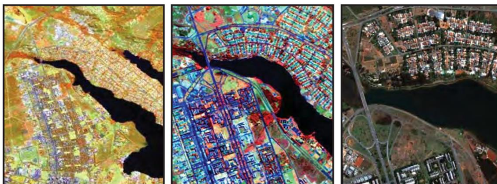
Figura 3 – Da esquerda para a direita, imagens dos satélites, Landsat com resolução espacial de 30m, Spot com 10 m e Ikonos com 1 m, de uma porção do lago Paranoá de Brasília. Fonte: Meneses e Almeida (2012).
