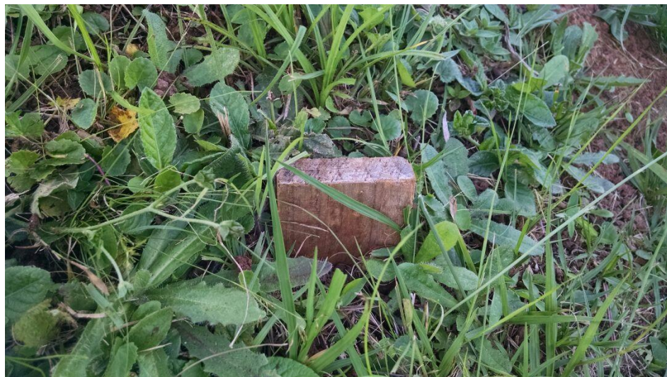
Figura 12 – Piquete posicionado rente ao perfil do terreno Fonte: Os Autores, 2015
