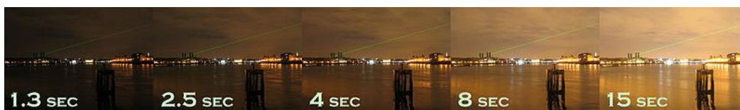
Figura 5 - Comparativo da qualidade das fotografias em diferentes tempos de exposição para uma mesma abertura do diafragma
