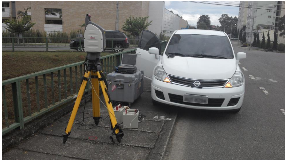
Figura 16 – Escâner a Laser Terrestre, Notebook e baterias. Fonte: Os Autores, 2014
