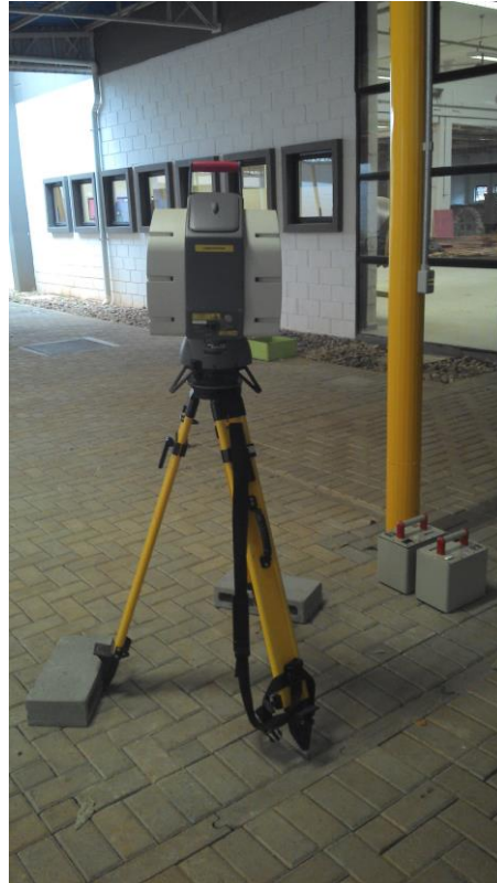
Figura 9 – Imagem do Escâner a Laser Terrestre Cyrax HDS 3000
