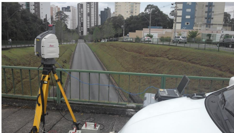
Figura 14 – Escâner a Laser Terrestre posicionado sobre o mesmo local da Estação Total. Fonte: Os Autores, 2014
