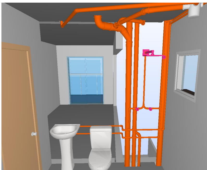
Figura 20: Projeto de instalações hidráulicas do banheiro.
