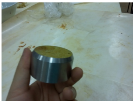
Figura 30 – Corpo de prova talhado com molde metálico Fonte: Autoria própria (2015)
