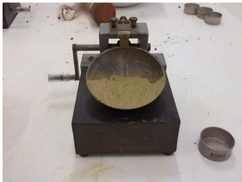
Figura 27 – Ensaio de limite de liquidez realizados Fonte: Autoria própria (2015)
