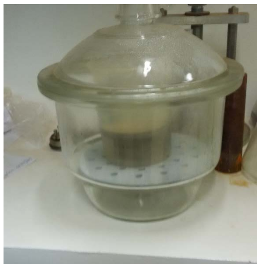
Figura 32 – Pedra porosa sendo saturada dentro da dessecadora Fonte: Autoria própria (2015)
