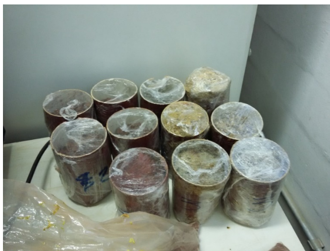
Figura 22 - Armazenamento dos horizontes indeformados coletados Fonte: Autoria própria (2014)
