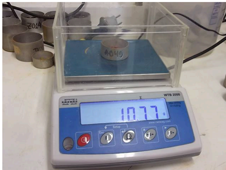
Figura 24 - Cápsulas sendo pesadas logo após a coleta para determinação da umidade in situ de um dos horizontes Fonte: Autoria própria (2014)
