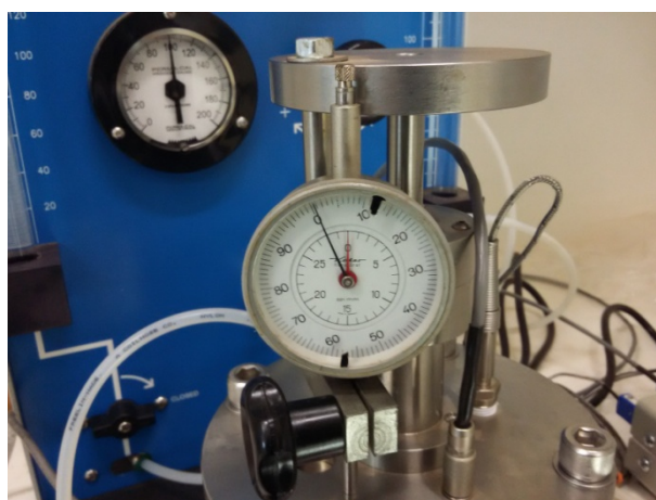
Figura 36 – Extensômetro utilizado no ensaio Fonte: Aatoria própria (2015)
