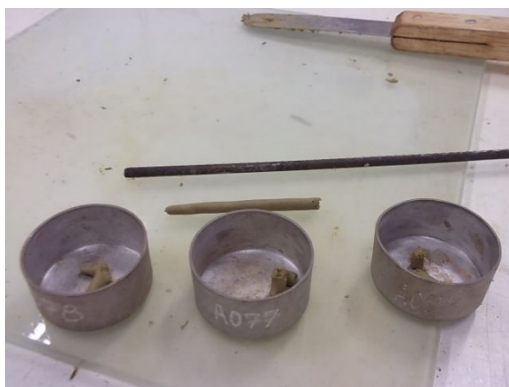
Figura 28 – Ensaio do limite de plasticidade Fonte: Autoria própria (2015)
