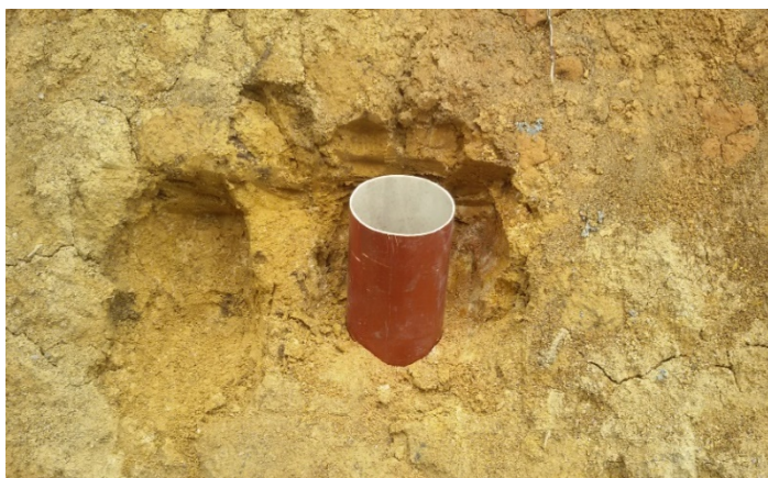
Figura 21 - Posicionamento do tubo de PVC no corte da bancada de trabalho Fonte: Autoria própria (2014)
