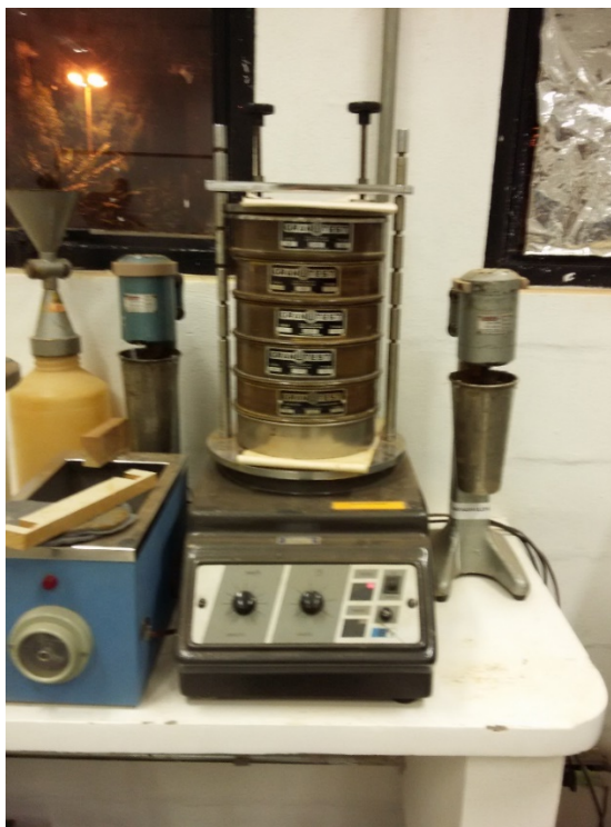
Figura 25 - Ensaio de Granulométrico Fonte: Autoria própria (2015)
