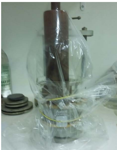
Figura 31 – Esquema do Becker utilizado no ensaio já drenado Fonte: Autoria própria (2015)
