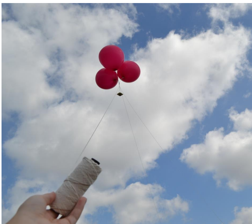
Figura 16 - Sistema balões e câmera guiada por três fios de barbante Fonte: Autoria própria
