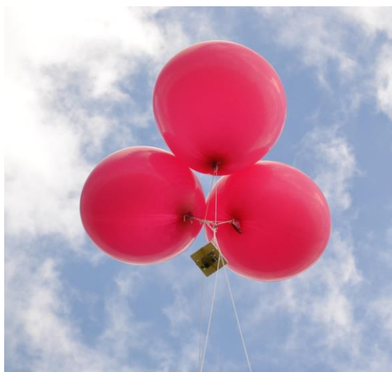
Figura 15 - Sistema balões e câmera
