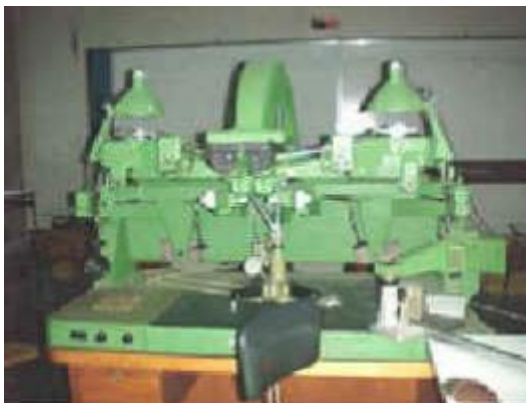
Figura 2 - Restituidor Analógico Wild B8 Fonte: Universidade Estadual do Rio de Janeiro
