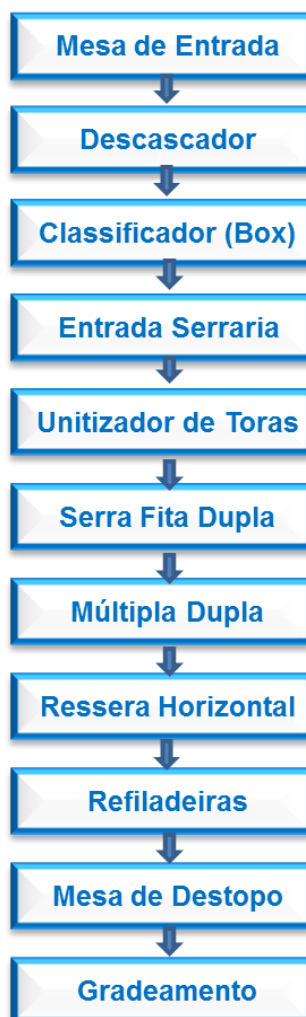
Figura 9 - Fluxograma do Desdobro Adotado para as Toras de Pinus Fonte: Autoria própria (2016)
