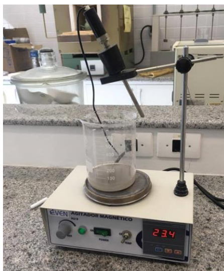
Figura 20: Aquecimento da mistura de pó de concreto, água e ácido clorídrico Fonte: O autor (2016)
