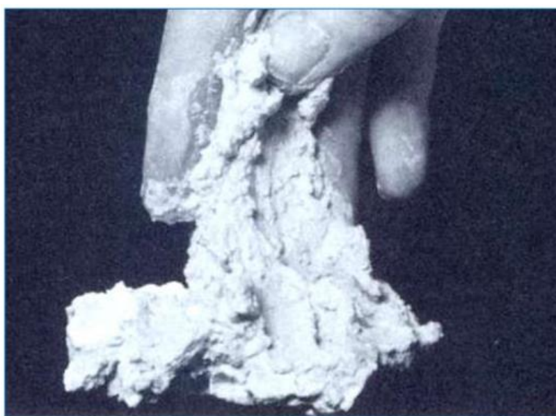
Figura 8: Concreto atacado por íons sulfato com formação de taumasita Fonte: Thomaz (2016)
