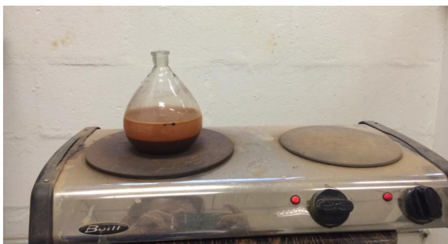
Figura 8 - Ensaio de Determinação da Massa Específica Real dos Grãos Fonte: A autoria própria.
