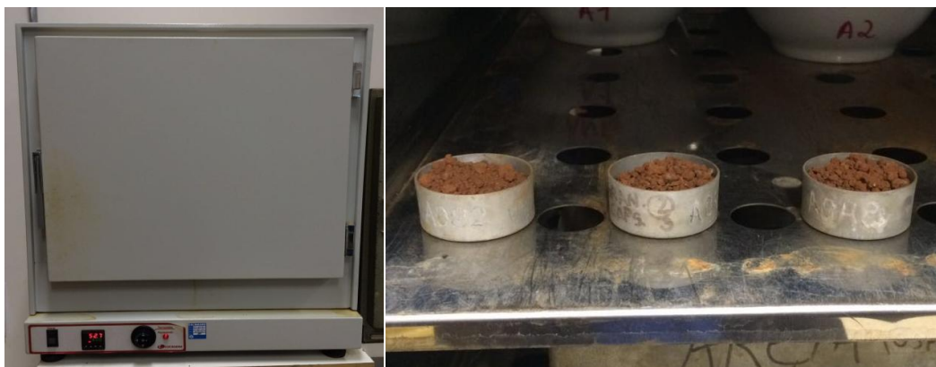
Figura 7 - Estufa e Cápsulas para o Ensaio da Determinação da Umidade Higroscópica Fonte: A autoria própria.
