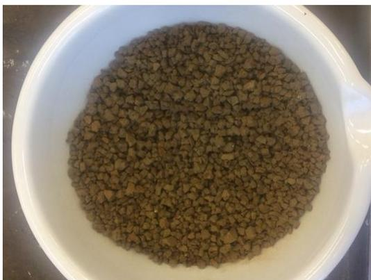
**Figura 20 – Lodo seco e destorroado**
