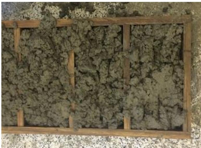
**Figura 33 – Concreto, no estado fresco, com teor de 5,0% de lodo úmido**
