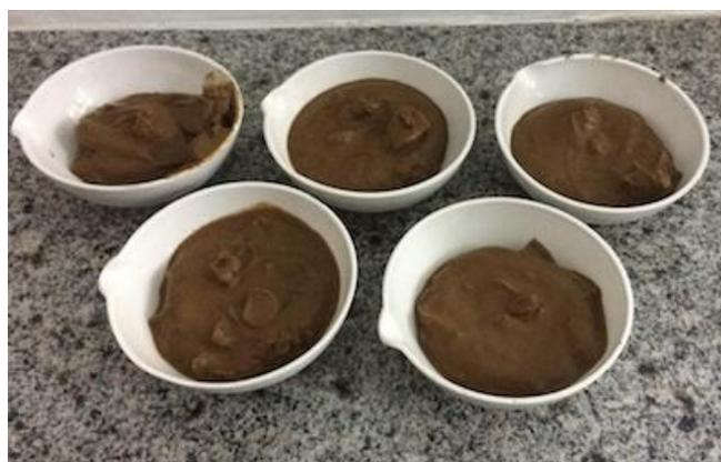
**Figura 29 – Lodo úmido com oxidante após 24h**
