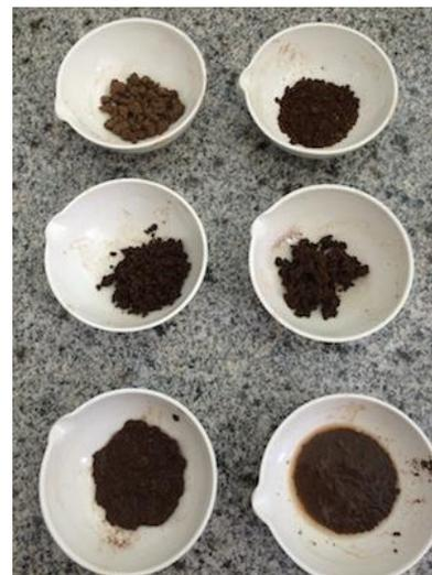
**Figura 32 – Lodo seco com oxidante após 24 horas**
