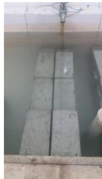
**Figura 25 - Peças em cura submersa**
