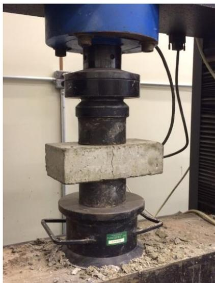
**Figura 26 - Resistência à compressão**
