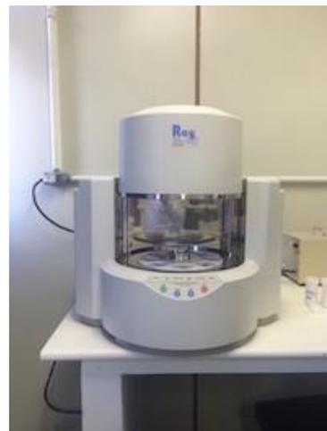
**Figura 18 – Espectrofotômetro de raio-X**
