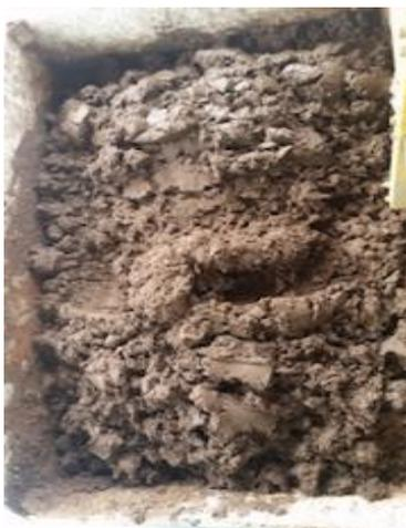
**Figura 11 - Lodo centrifugado**
