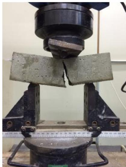
**Figura 27 - Resistência à tração na flexão**
