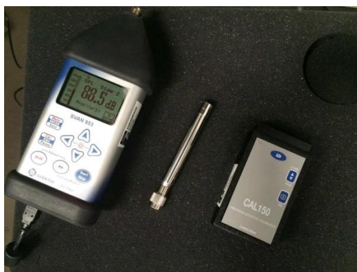
Figura 27 - Analisador, microfone e calibrador
