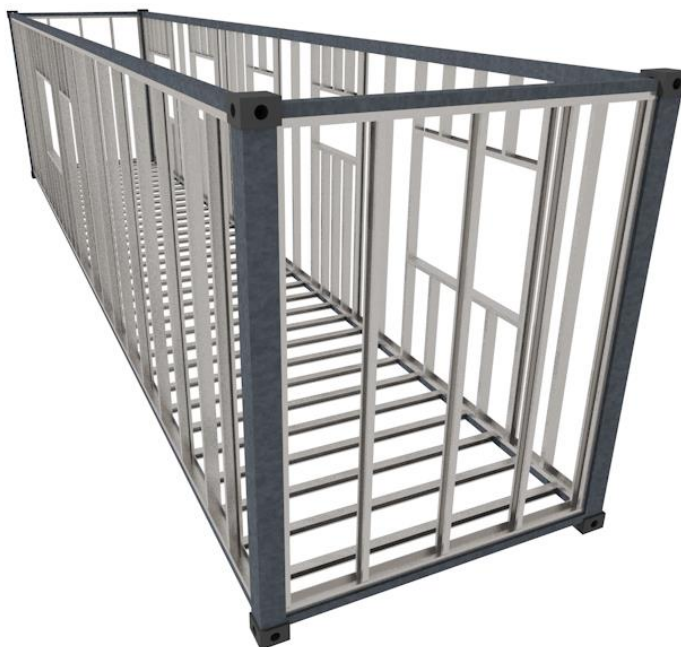
Figura 26 - Estrutura metálicas modeladas em ArchiCAD
