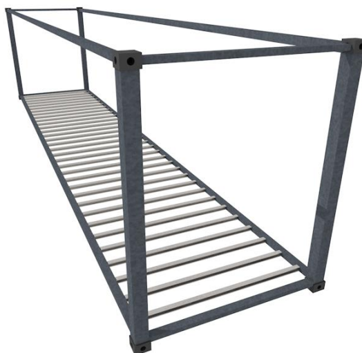
Figura 21 - Componentes da estrutura principal de um container
