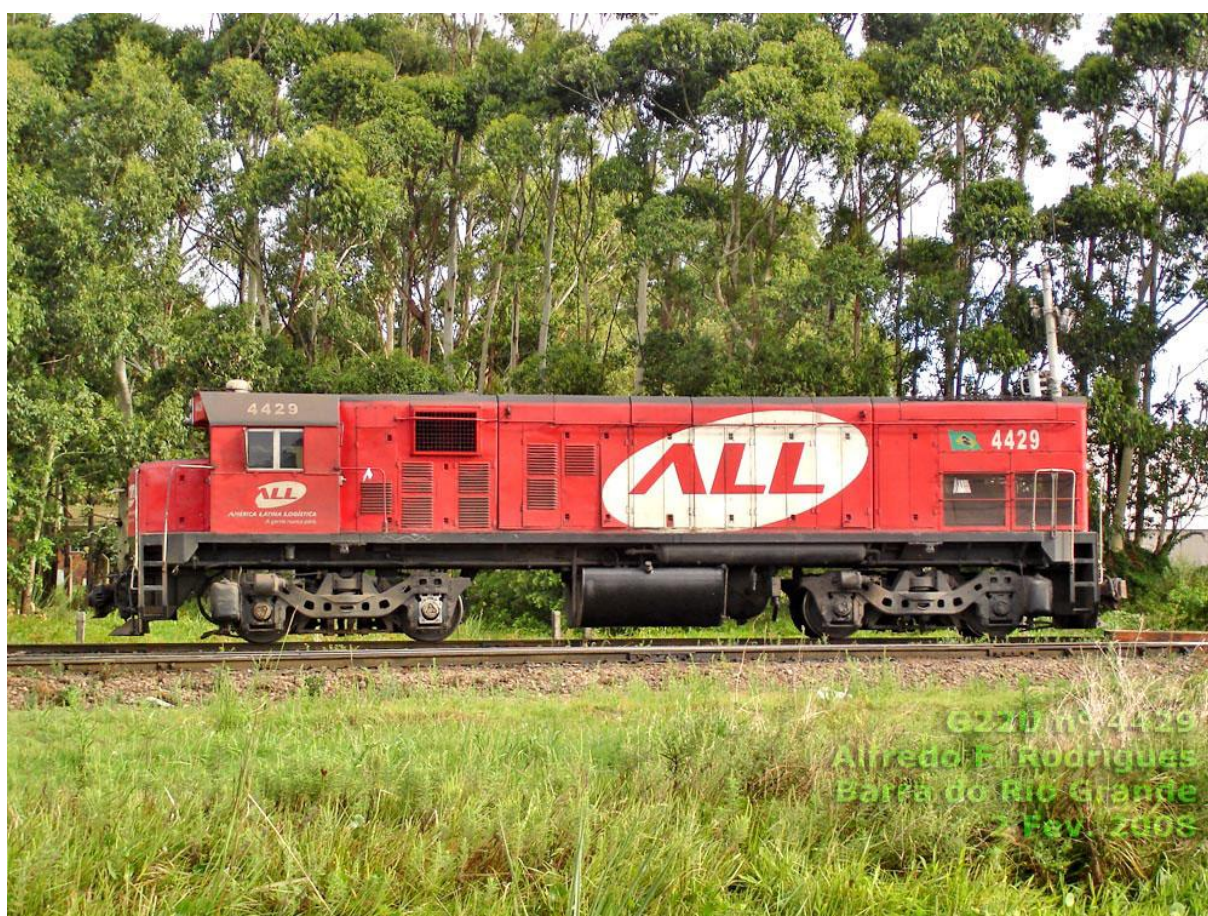
Figura 15: Locomotiva modelo G22U, com rodagem B-B Fonte: VFCO (2016)
