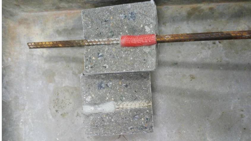
Figura 9 - Ruptura do corpo de prova de concreto auto adensável
