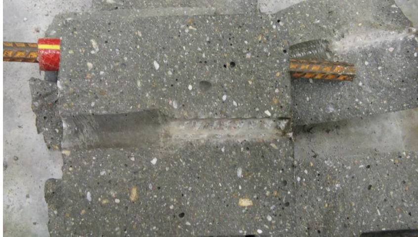
Figura 11 - Ruptura do corpo de prova de concreto pós reativo
