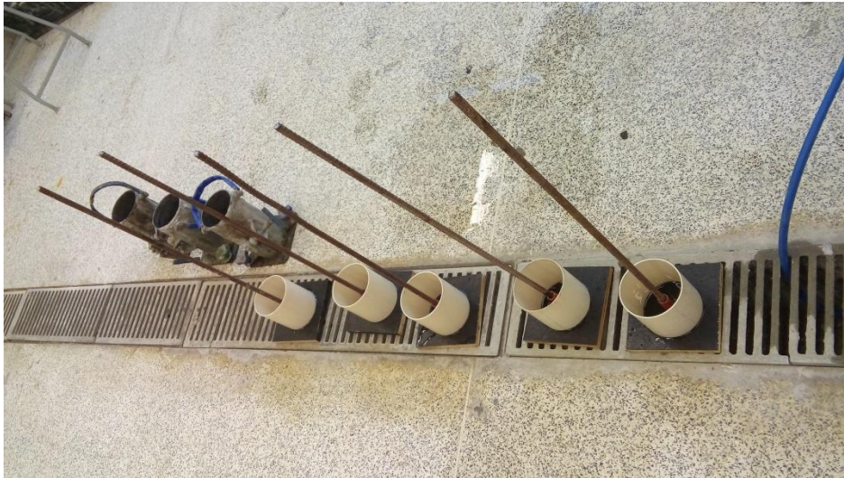
Figura 4 - Moldes montados antes da concretagem
