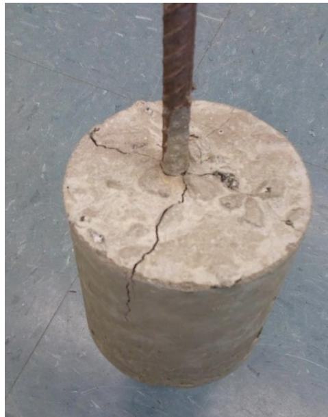
Figura 8 - Ruptura do corpo de prova de concreto convencional
