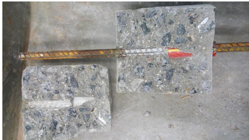
Figura 10 - Ruptura do corpo de prova de concreto alto desempenho
