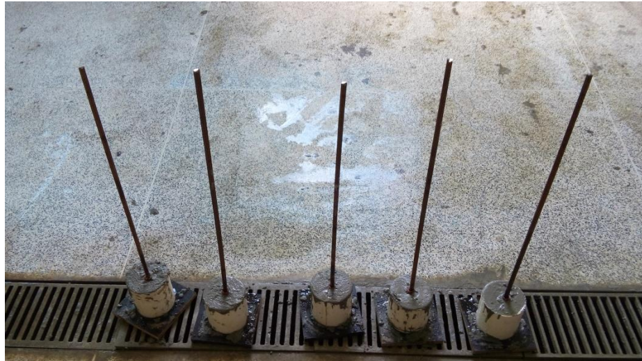
Figura 5 - Corpo de prova concretados para ensaio de arrancamento
