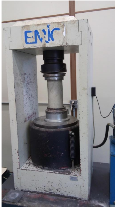
Figura 7 - Configuração do ensaio de compressão axial
