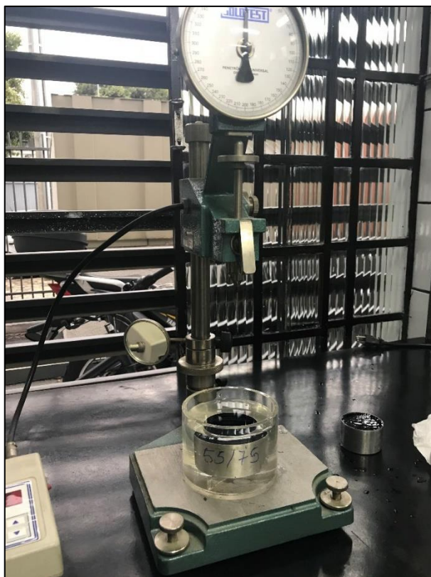
Figura 10 - Determinação da Penetração – CAP 55/75 Fonte: Autoria Própria
