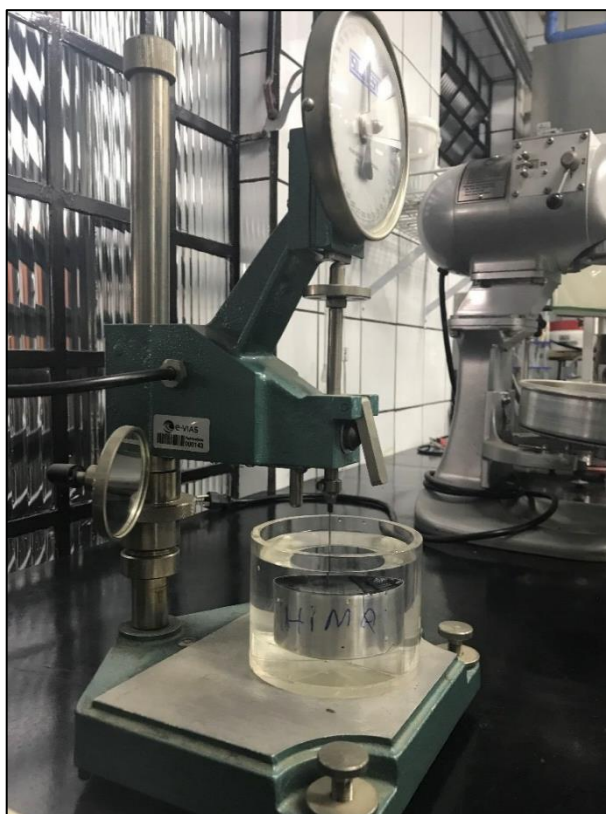
Figura 11 - Determinação da Penetração – HIMA Fonte: Autoria Própria
