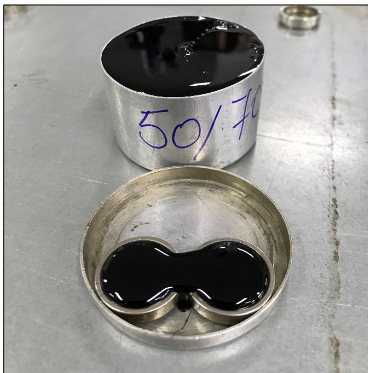
Figura 12 - Corpo de Prova – Determinação do Ponto de Amolecimento - CAP 50/70 Fonte: Autoria Própria
