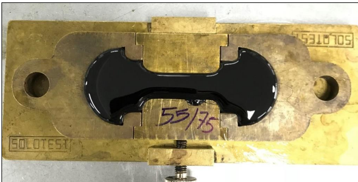
Figura 18 - Corpo de Prova - Recuperação Elástica – CAP 55/75 Fonte: Autoria Própria
