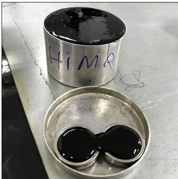
Figura 14 - Corpo de Prova – Determinação do Ponto de Amolecimento HIMA Fonte: Autoria Própria
