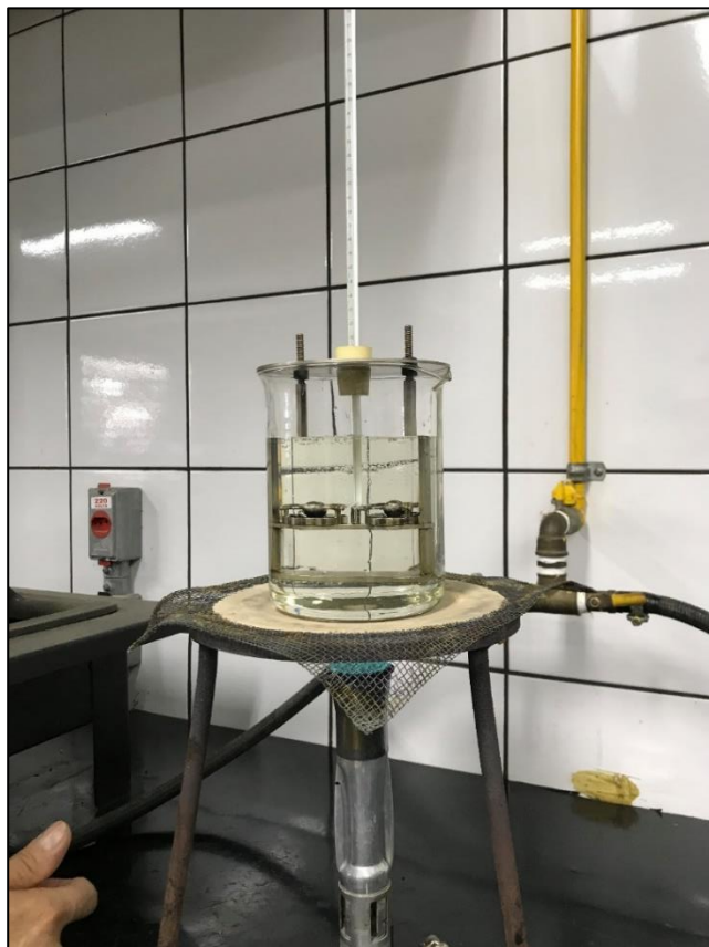
Figura 15 - Determinação do Ponto de Amolecimento – Método Anel e Bola Fonte: Autoria Própria
