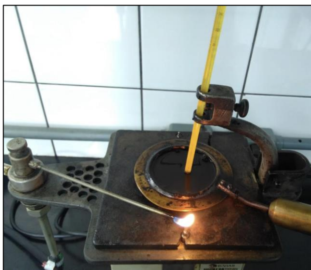
Figura 17 - Determinação do Ponto de Fulgor Fonte: Autoria Própria
