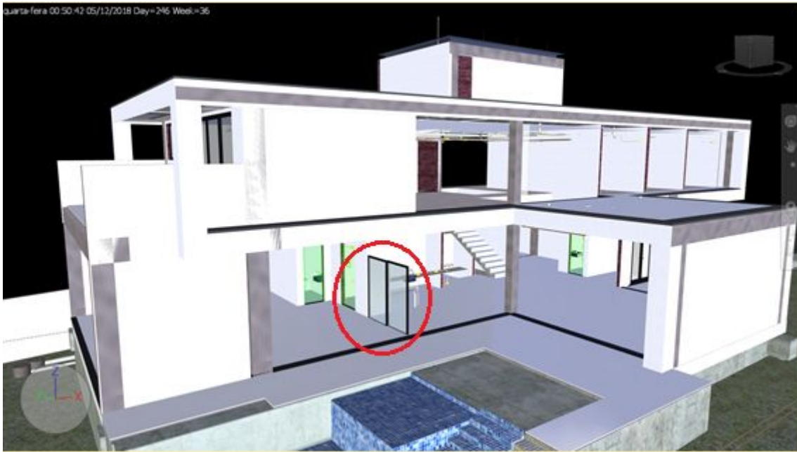
Figura 43 – Simulação do cronograma: porta de alumínio instalada sem fixação FONTE: Autoria própria.
