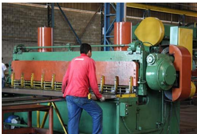
Figura 1 – Processo de fabricação de um perfil formado a frio FONTE: (GLOBESTEEL, 2015)
