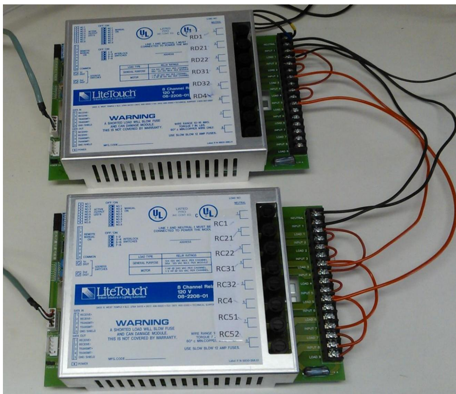
Figura 28 – Conexão entre os relés Fonte: Autoria própria
