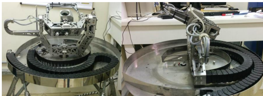
Figura 37: Bancada de calibração posicionada para ensaio com giroscópio em paralelo ao eixo de rotação do planeta e rotacionado em 180 graus
