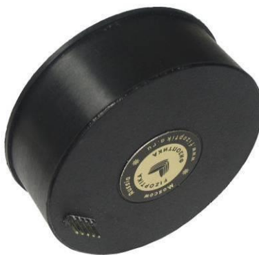
Figura 51: Giroscópio óptico Fizoptika VG949PD
