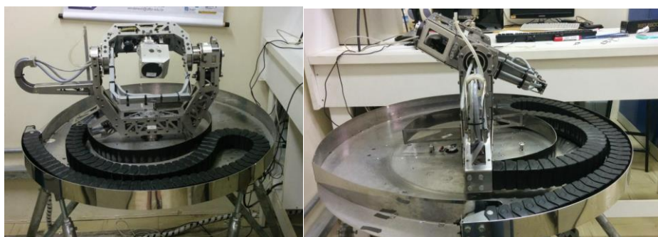
Figura 36: Bancada de calibração posicionada para ensaio com giroscópio em paralelo ao eixo de rotação do planeta
