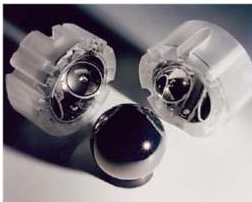
Figura 5: Esfera contendo 4 giroscópios usados na GP-B (NASA)
