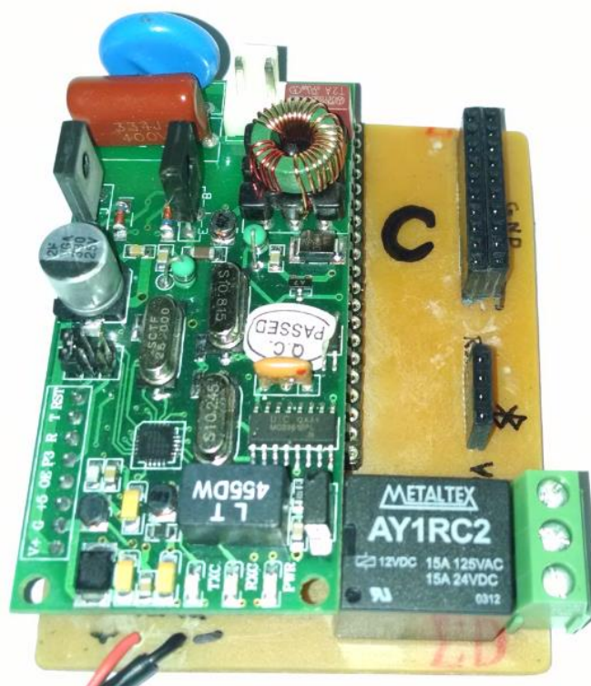
Figura 24: Foto do módulo formado pela placa microcontrolada e pelo módulo PLC. Fonte: Autoria própria.
