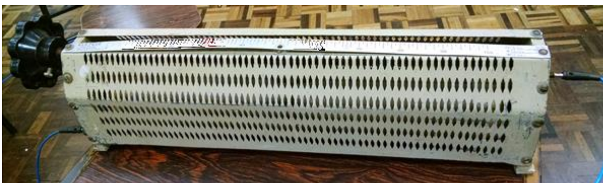
Figura 20: Reostato para variar a carga na rede.
