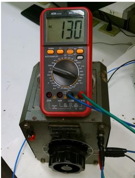
Figura 19: Variac para varia a tensão de 0V até 147V.
