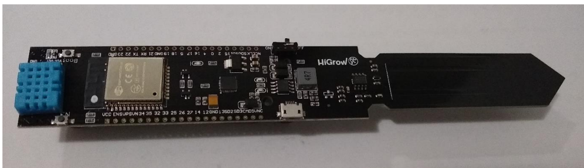
Figura 20: Sensor capacitivo com comunicação Bluetooth
