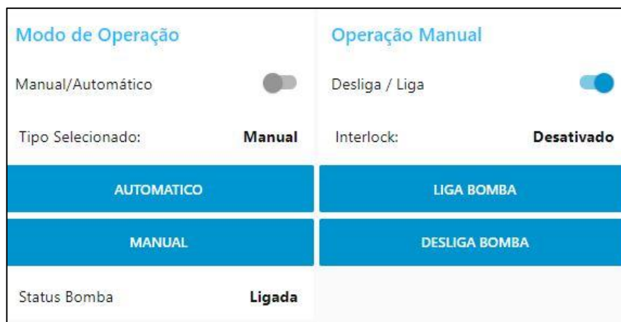
Figura 37: Interlock desativado em modo de operação manual
