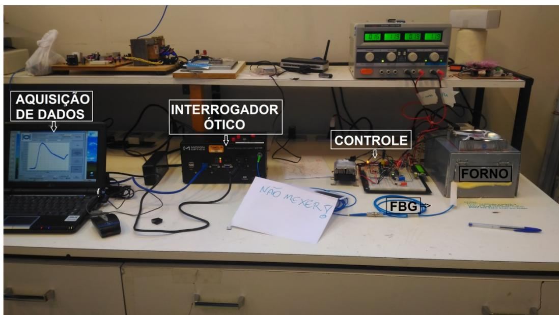
Figura 14. Sistema de leitura para validação da estabilidade térmica da câmara.
