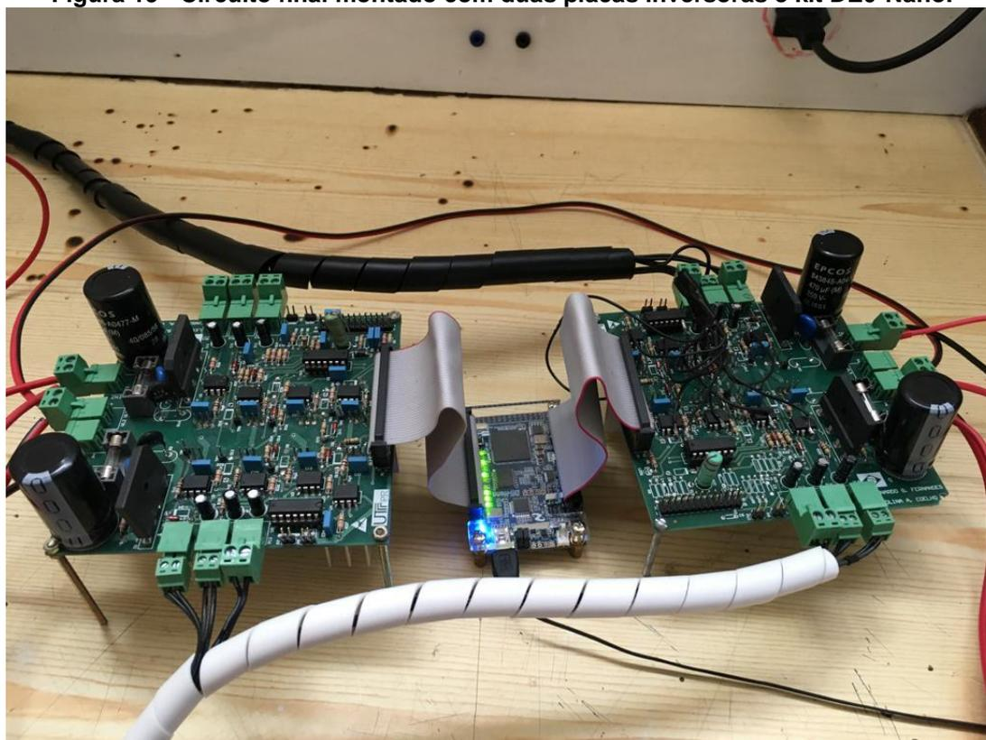
Com o auxílio do osciloscópio Tektronix MSO 2024B para verificação dos sinais gerados, foram realizados 3 testes diferentes para cada uma das 4 modulações. Em todos eles houve a alimentação de 6 fontes CC isoladas de 15 V na saída dos optoacopladores. Também utilizou-se uma fonte de alimentação simétrica modelo Minipa MPL-3303 (30 V/3 A) com saída de 20 V, para representar o SDCS, conforme a Figura 1.
