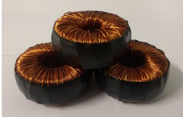
Figura 39 – Aspecto final dos indutores com núcleo toroidal construídos.
