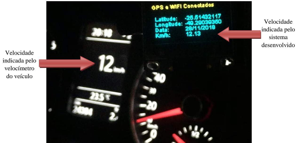
Figura 24 – Teste veicular de comparação de velocidade.
