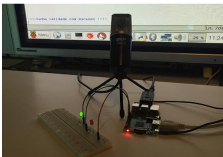
Figura 21 - Validação do usuário indicado pelo acionamento do LED verde.
