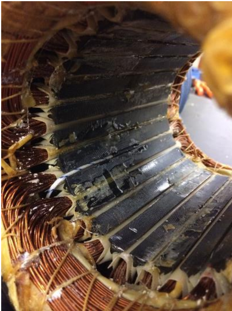
Figura 18: Termopar instalado na ranhura do estator.
