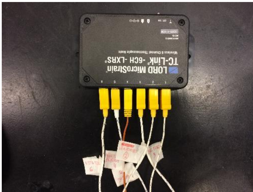
Figura 8: Termopares tipo K conectado ao sensor.
