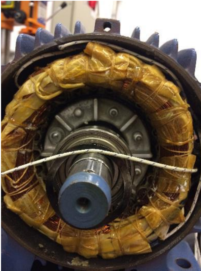
Figura 22: Termopares instalados nas juntas do enrolamento.
