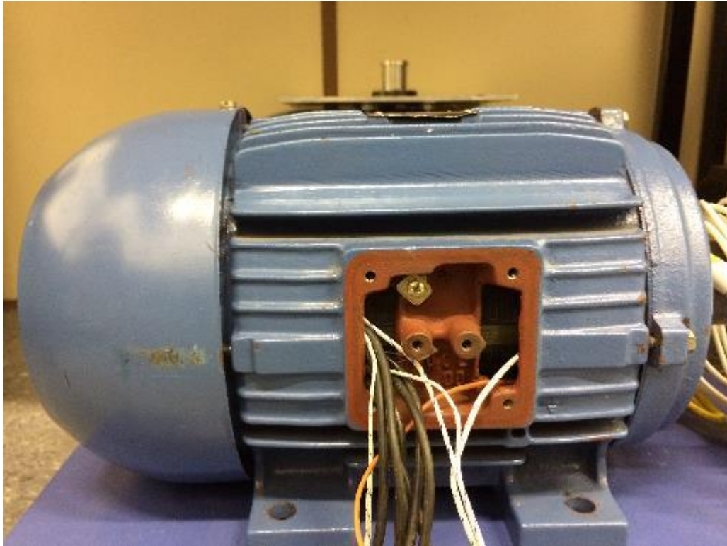
Figura 5: Motor de indução trifásico WEG.
