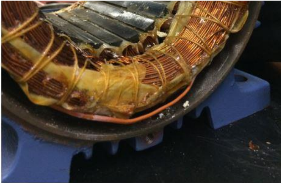
Figura 21: Termopar instalado na junta do enrolamento.
