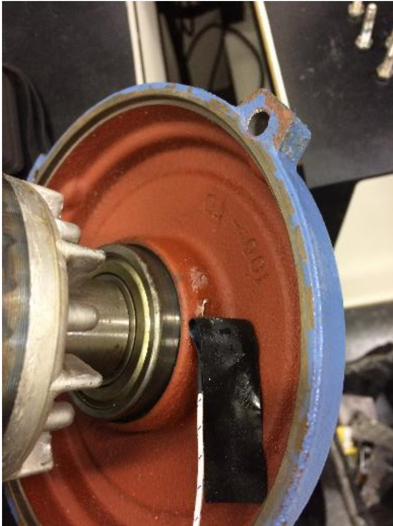
Figura 20: Termopar instalado na tampa do rolamento do eixo.
