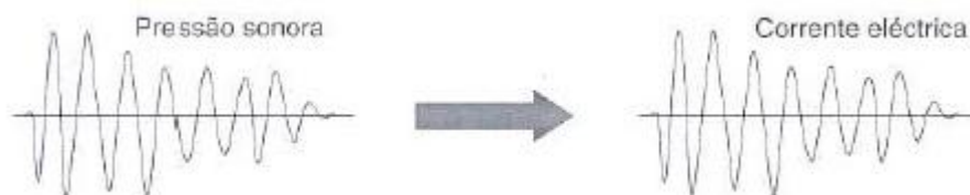
Figura 16 - O microfone converte variações da pressão sonora em variações de corrente elétrica.
