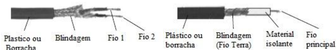
Figura 24 - Cabo de baixa impedância e alta impedância respectivamente. FONTE: MILSTEAD (2003, p. 34).
