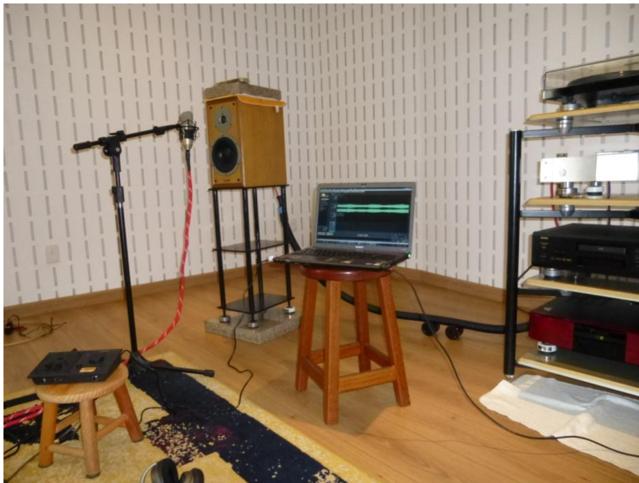
Figura 40 - Técnica de recapturação de áudio através da reprodução em um aparelho de alta fidelidade. FONTE: Autor.
