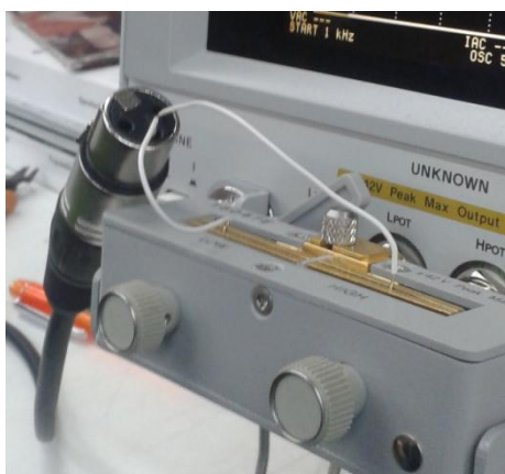
Figura 90 - Procedimento de medição das especificações dos cabos. FONTE: Autor.
