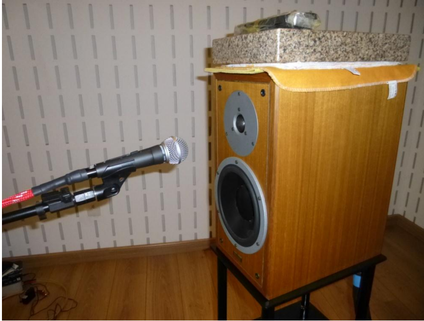
Figura 57 - Recapturação da gravação de um áudio de violão com o microfone Shure SM58. FONTE: Autor.
