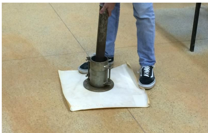
Figura 16- Ensaio de compactação de solo
