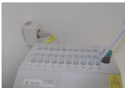
**Figura 17 - Foto de amostras (ensaio com *Vibrio fischeri*) sendo colocadas nas cubetas do termobloco a  $15^\circ \text{ C}$ .
