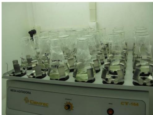
**Figura 20** – Agitador orbital com as amostras para Ensaio com a alga *Desmodesmus subspicatus*.
