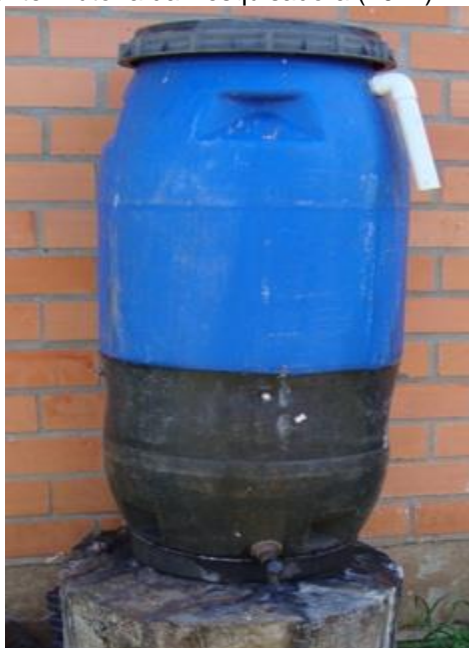
Fotografia 11 – Biodigestor elaborado com tonéis de combustível. Fonte: Aatoria da Pesquisadora (2012).
