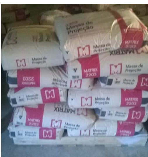
Figura 21 - Armazenamento de argamassa para projeção Fonte: Autor
