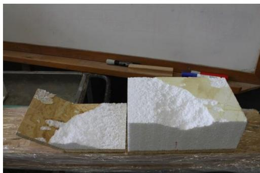
**Figura 12 – CP4 EPS F3: Ruptura na compressão axial**
