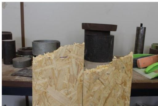
**Figura 19 – CP1 OSB: Ruptura na flexão simples reta**
