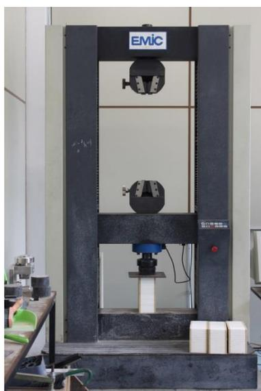
**Figura 6 – CP 1 EPS F5: Ensaio de compressão axial**
