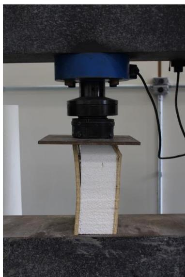
**Figura 10 – CP3 EPS F4: Ruptura na compressão axial**
