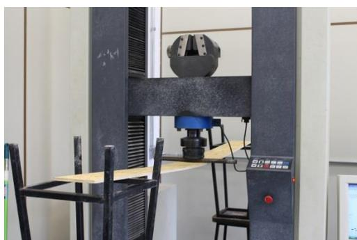
**Figura 17 – CP1 OSB: Ensaio de flexão simples reta**
