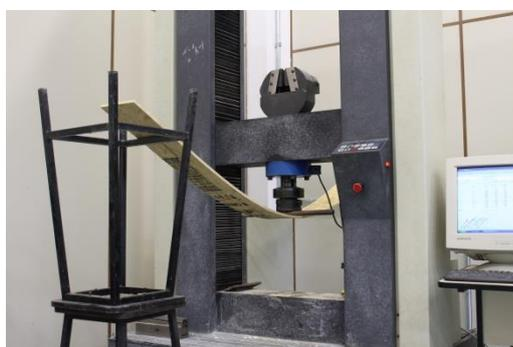
**Figura 20 – CP6 OSB: Ensaio de flexão simples reta**
