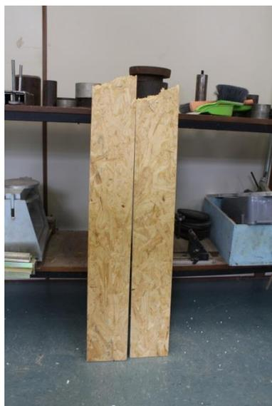
**Figura 18 – CP1 OSB: Ruptura na flexão simples reta**
