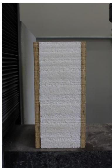
**Figura 9 – CP2 EPS F3: Ruptura na compressão axial**
