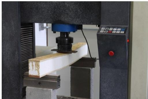
**Figura 13 – CP4 EPS F5: Ensaio de flexão simples reta**
