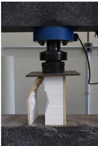
**Figura 11 – CP4 EPS F3: Ruptura na compressão axial**
