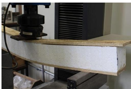
**Figura 14 – CP4 EPS F5: Ruptura na flexão simples reta**
