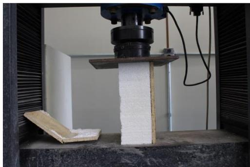
**Figura 8 – CP3 EPS F5: Ruptura na compressão axial**
