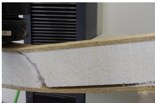
**Figura 15 – CP7 EPS F5: Ruptura na flexão simples reta**
