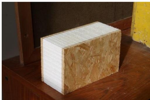
**Figura 5 – Corpos de prova para ensaio de compressão axial**
