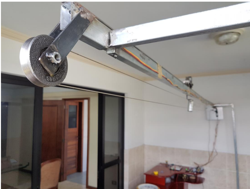
Figura 17 - Roldana de fim de trilho e sensor reflexivo Fonte: Autoria própria
