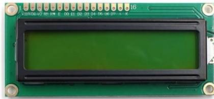
Figura 24 - Display LCD 16x2 (<http://www.eletródex.com.br>).
